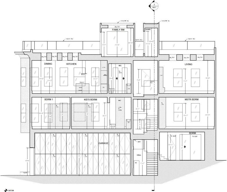
1 EXISTING LONGITUDINAL SECTION
